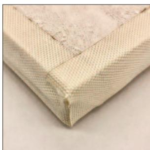
Vacunanex® Roof è un materiale tecnologicamente avanzato ad altissime prestazioni isolanti, composto da cellule micronizzate di polveri a base di ossidi di silice e confezionato sottovuoto. Successivamente è rivestito da una lastra in cemento sp.3mm per lato. Il 10% delle polveri proviene da sottoprodotto Microbifire da polveri di recupero. Scheda tecnica sottoprodotto rif. A03810050.
